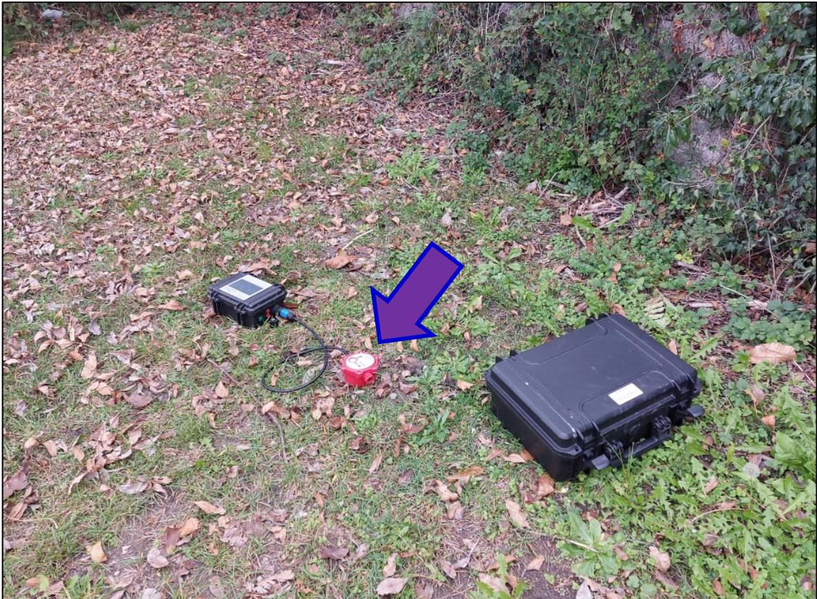
Fig. 12 – Punto di esecuzione indagine di sismica passiva HVSR con strumentazione ECHO TROMO HVSR 3
