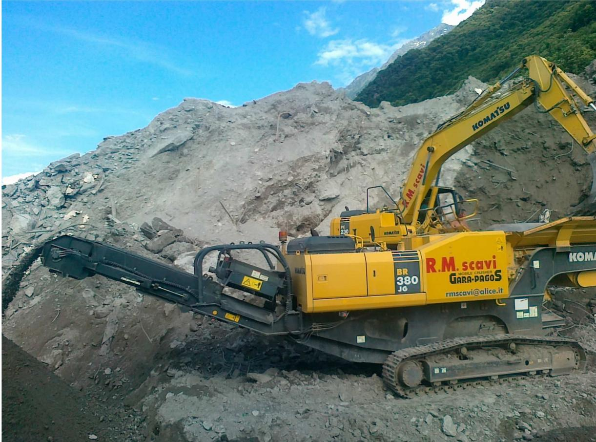
Figura 5 Riduzione volumetrica con impianto mobile di frantumazione
