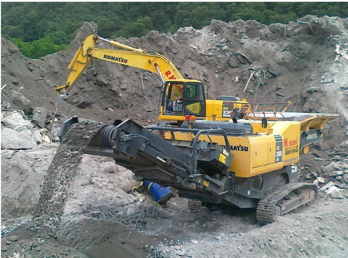
Figura 6 Riduzione volumetrica con impianto mobile di frantumazione
