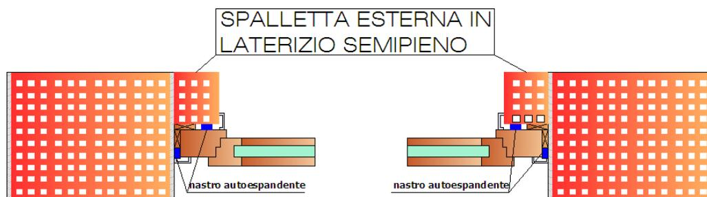
Figura 6: Spalletta in muratura per la posa del serramento
