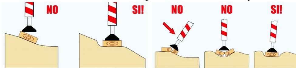
E' necessario posizionare gli stabilizzatori lontano da buche, scarpate, scavi mantenendo la distanza di sicurezza (distanza dal ciglio maggiore della profondità dello scavo). Durante il pompaggio possono avvenire cedimenti del terreno causati da vibrazioni, è quindi necessario verificare costantemente la stabilità della macchina sul piano di appoggio.
