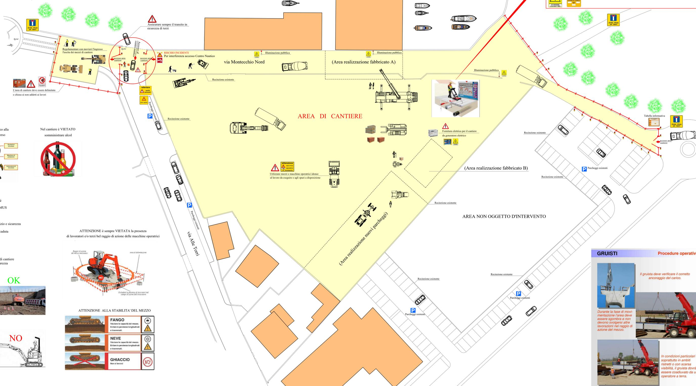
**ATTENZIONE:** all'interno dell'area di cantiere vi è sicuramente la presenza di reti tecnologiche interrato (elettricità - gas - ecc.) E' necessario preventivamente rilevare e segnalare in superficie il percorso e la profondità degli elementi e stabilire le modalità di esecuzione dei lavori tali da evitare l'insorgenza di situazioni pericolose sia per i lavori da eseguire sia per l'esercizio delle reti.
