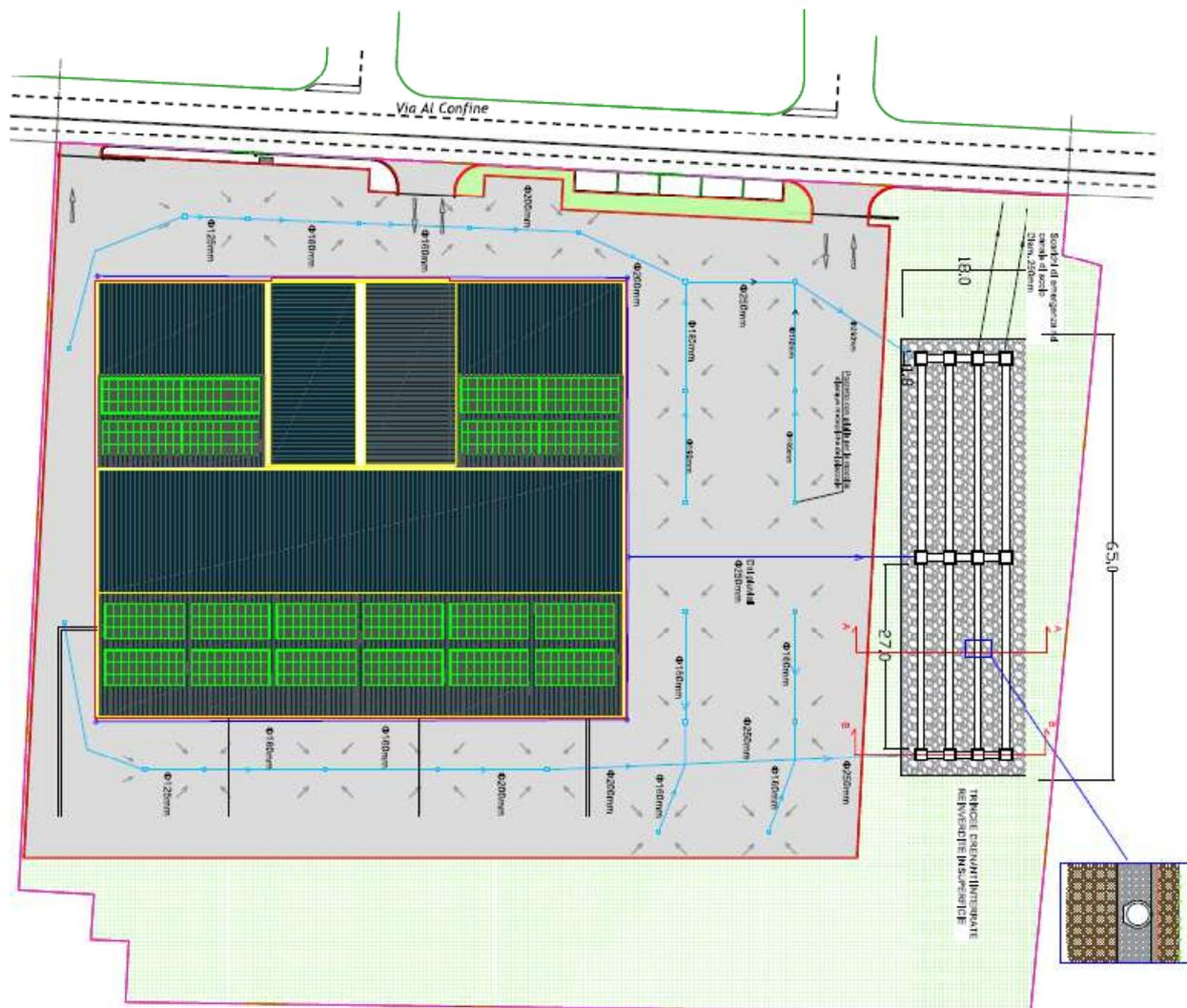
Figura 3.7: Rete di raccolta acque meteoriche e sistema di infiltrazione in sottosuolo (estratto da Progetto invarianza)
