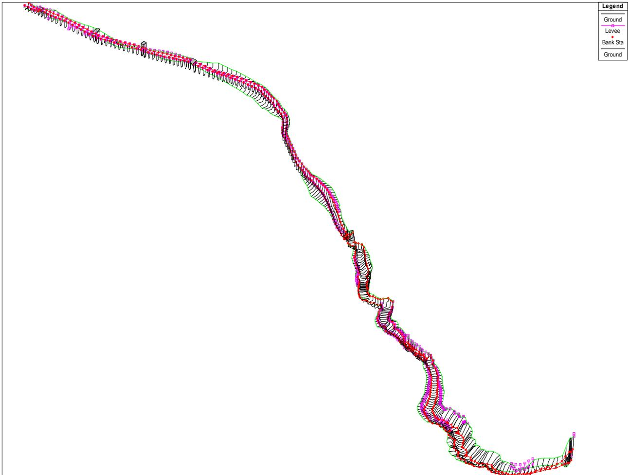
Figura 15 – Modellazione della geometria del Torrente Perlino con Hec-Ras dalla prima vasca di accumulo in località Posallo allo sbocco nel lago di Como.
